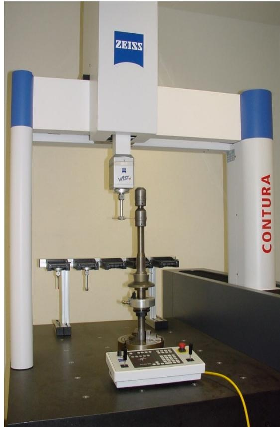
3D-Messzentrum Contura mit VAST-Technologie und CNC-Technik
