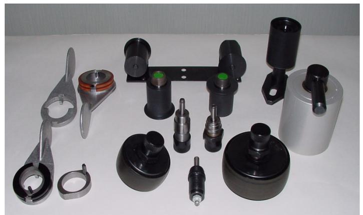
Antriebselemente für den Spindeltrieb
